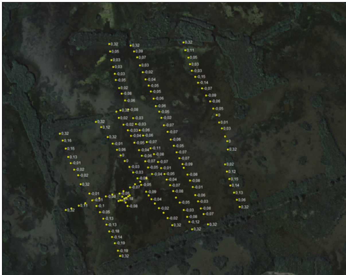
Figure 4 : Relevés bathymétriques sur le bassin 0 des Grandes Cabanes du Vaccarès (les cotes sont exprimées en mNGF calées à l'échelle limnimétrique).
